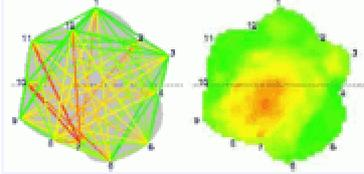
Schalltomographie an einem Baumstamm. Liniengrafik und Tomogramm. Die grünen Flächen stellen intakte, die roten Flächen schadhafte Bereiche im Stamm eines Baumes dar.
