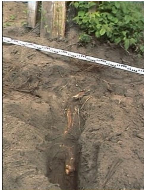
Mit der PICUS-Wurzeldiagnose kann das Ausmaß solcher Wurzelschädigungen nach Baumaßnahmen quantifiziert werden, ohne dass Aufgraben
